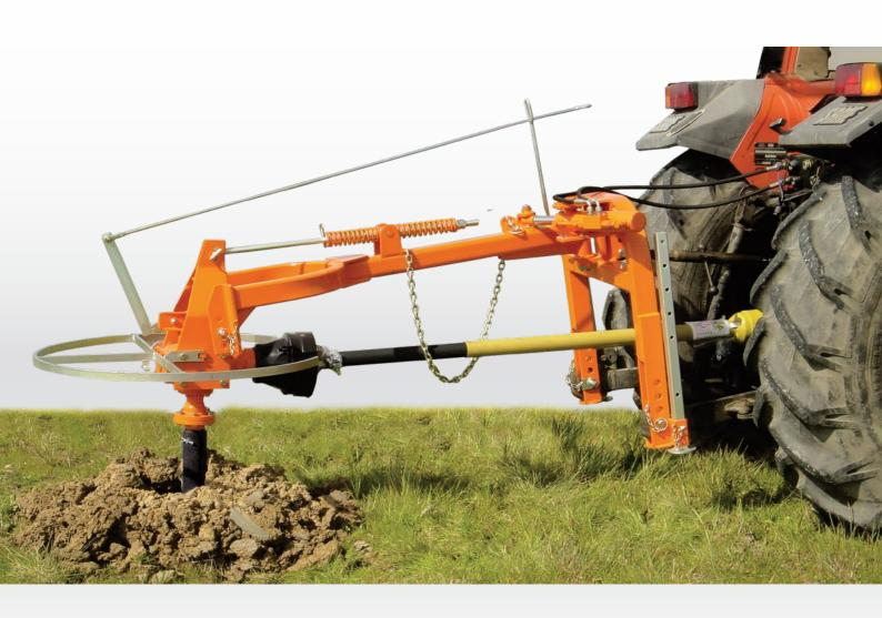
BGM/BGH/ BROCADORAS-PERFURAD AXIAIS E DESCENTRADAS MONTAGEM NOS 3 PONTO
