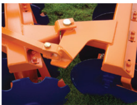
Articulação dos corpos dos discos. Articulación de los cuerpos de los discos. Articulations des corps des discs. Disc gang angling.
