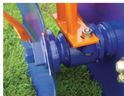
Chumaceiras de rolamentos auto lubrificadas. Cubos de rodamientos auto lubrificadas. Paliers graissables avec roulements auto lubrifiants. Sealed taper roller bearings.
