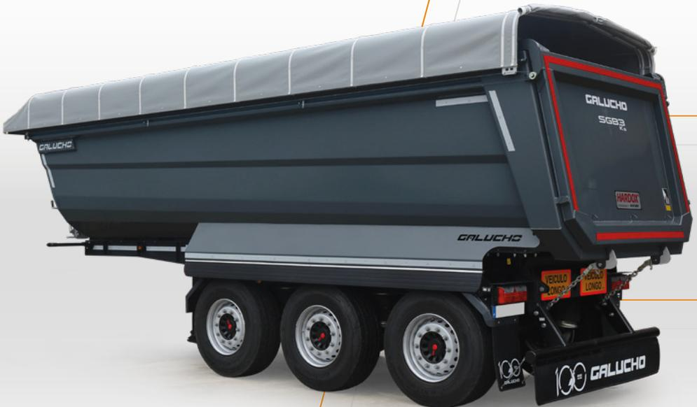
**SGB3** / SEMIRREMOLQUE BASCULANTE DE 3 EJES
